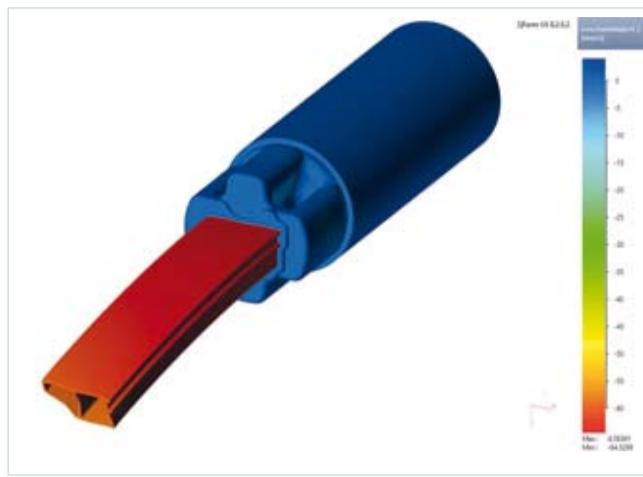
Simulation des Strangpressens einer Aluminiumlegierung mit analysengenaue Werkstoffdaten aus JMatPro
